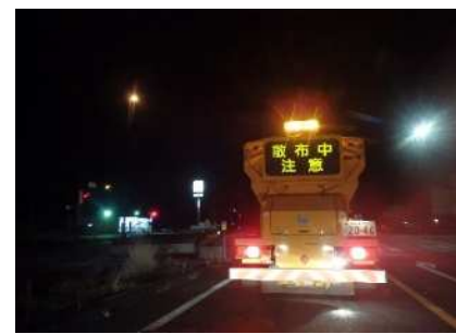
凍結防止剤散布工
