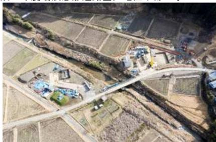
A2橋台 躯体施工中 用水付替工 施工中
