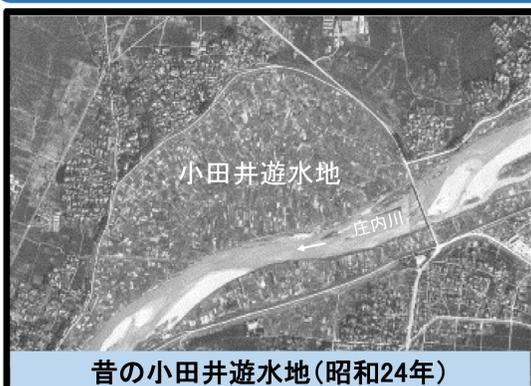
昔から庄内川と矢田川が合流するこの地では、右岸側に遊水帯(洪水が氾濫する所)が自然にでき洪水の勢いを和らげる役割をしていました。遊水帯のほとんどが農耕地として利用されていましたが、その後庄内川の治水計画の中で洪水時に計画的に流量を軽減する遊水地と位置付けられ、昭和53年から用地取得を行いながら囲繞堤(いにようてい)の築造に着手し昭和61年に小田井水門、昭和63年から越流堤に着手し平成元年に概成しました。
