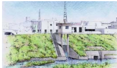
排水樋門の上屋設置及び樋門の電動化を行う
