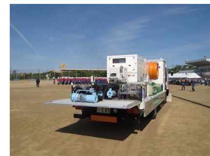
排水ポンプ車 （愛知県尾張地区水防総合演習）
