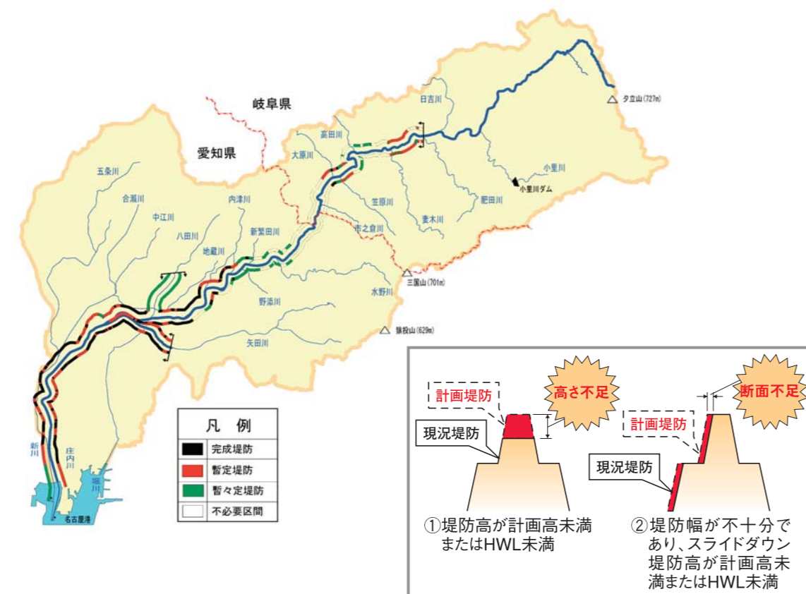
●図2.1.7 堤防の整備状況
