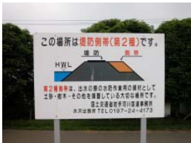
堤防側帯（北上川）：堤防側帯は水防活動等のために盛土して堤防の上幅を広げる方法
