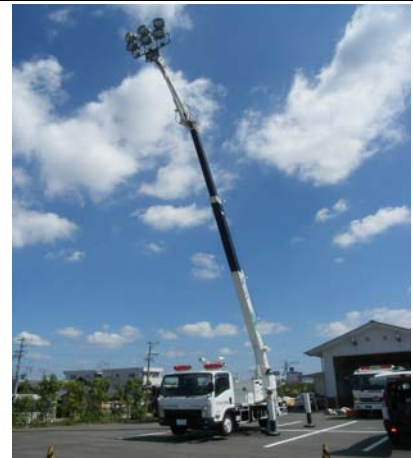
庄内川河川事務所 照明車(20m級)
