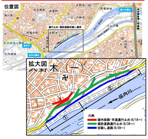
7月に降った雨の影響により道路部が一部崩れたため、延期を行った堤防道路切替について、 切廻し道路補強工事が完了したため、令和2年9月28日より堤防道路切替を行います。 令和2年9月28日より、■■■■の堤防道路を通行止めとし、■■■の切廻し道路通行となります。
