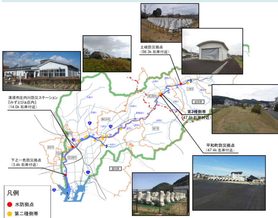
水防拠点の整備及び資材の常備
