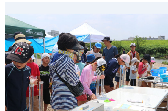
透視度計による水質調査状況
