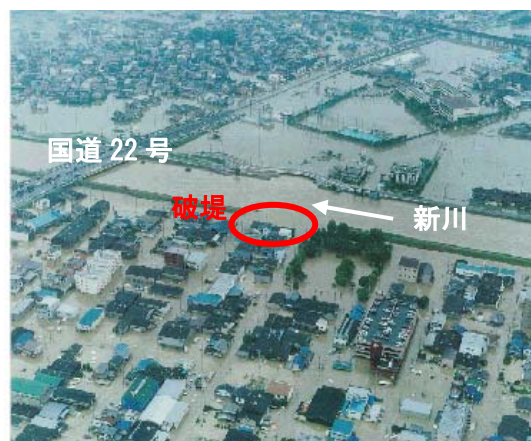
写真 2.1.3 新川の破堤地点の被災状況
