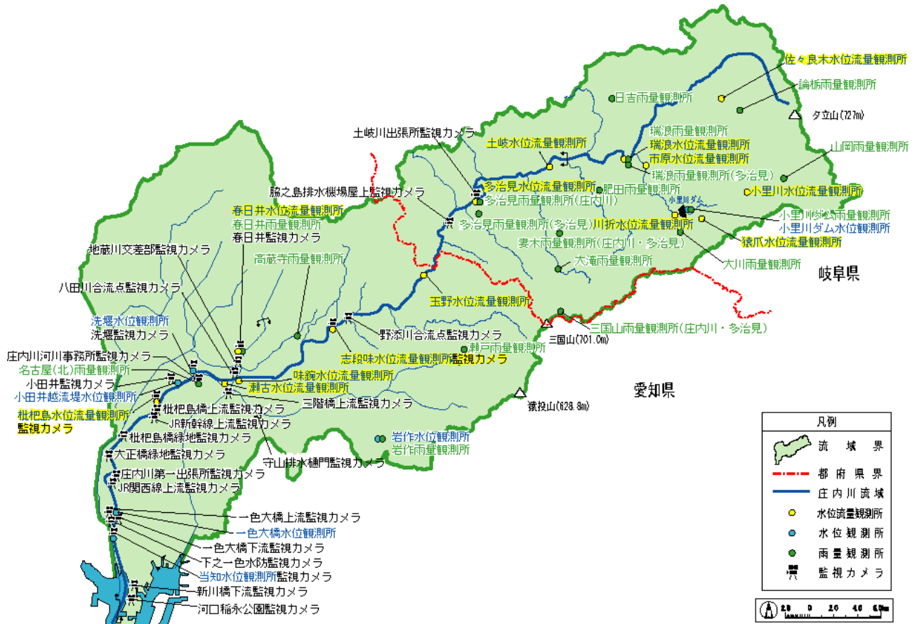
図-9.2 庄内川水系雨量水位観測所設置位置図
