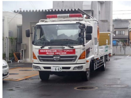
■ 派遣した排水ポンプ車
