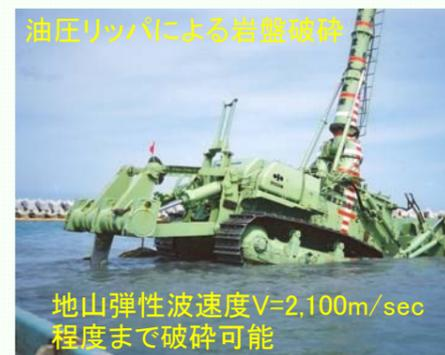
油圧リッパによる岩盤破碎
