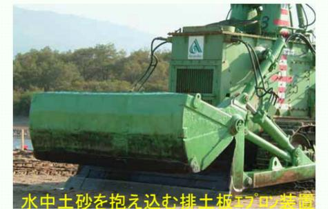
水中土砂を抱え込む排土板の設置
