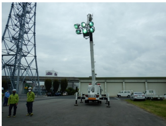
照明を点灯し、照明車の設置完了
