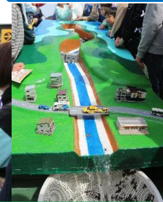
多治見砂防国道事務所も、模型を使った土石流が発生した場合の砂防ダムの実験や、御岳山に関する展示のほか、降雨体験車などを出展。
