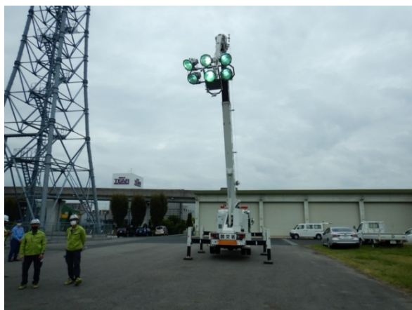
照明を点灯し、照明車の設置完了
