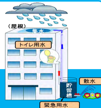
貯留槽に溜めた雨水を トイレ用水・散水等に利用
