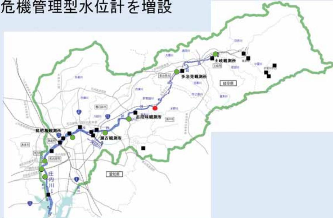
※危機管理型水位計は、洪水時ののみの水位観測に特化した低コストな機器で、従来は設置することが困難であった「洪水に対するリスクが高い箇所」などにも増設が可能となるなど、水位観測網を充実させることができ、避難行動につながるリスク情報をきめ細かく提供することができる。
