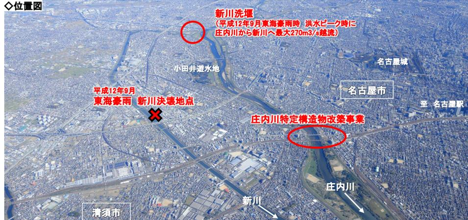
庄内川下流部の枇杷島地区（河口から14k付近）は、川幅が狭い狭窄部であるとともに桁下高が低く橋脚の間隔が狭い橋梁が連続して横河しており、洪水の流下に大きな支障が生じている。特に、平成12年9月東海豪雨では、県道枇杷島橋の桁下に洪水が衝突するなど危険な状況であった。このため、河川整備計画に基づき治水安全度の向上を図るため、「特定構造物改築事業」により、引堤及びそれに伴う3橋梁の架替を実施中。
