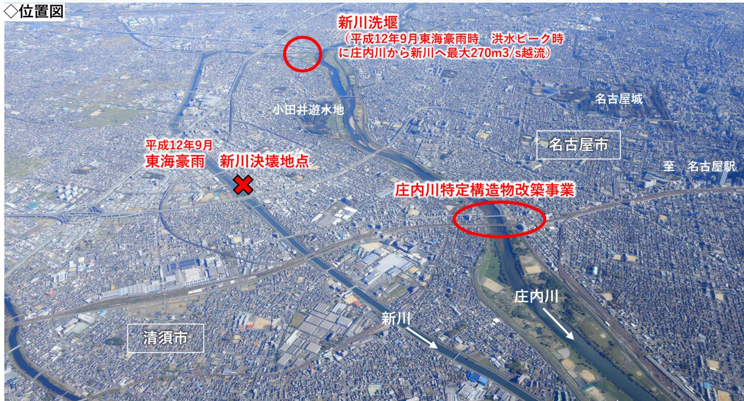
庄内川下流部の枇杷島地区（河口から14k付近）は、川幅が狭い狭窄部であるとともに桁下高が低く橋脚の間隔が狭い橋梁が連続して横河しており、洪水の流下に大きな支障が生じています。特に、平成12年9月東海豪雨では、県道枇杷島橋の桁下に洪水が衝突するなど危険な状況でした。
