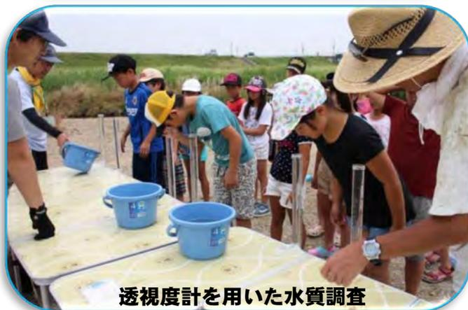
透視度計を用いた水質調査
