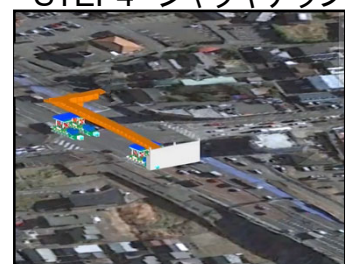
多軸台車による架設イメージ
