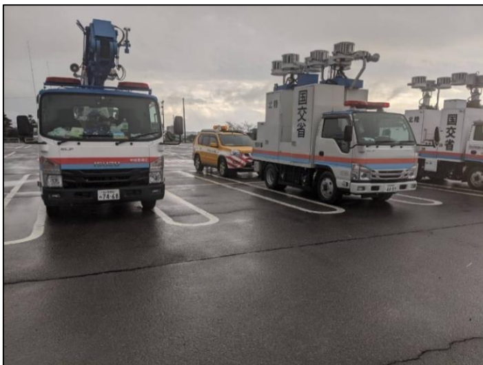
「珠州市役所近辺」で待機中の照明車(20m級1台)
