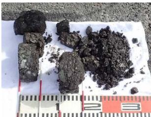
舗装内部の損傷状況
