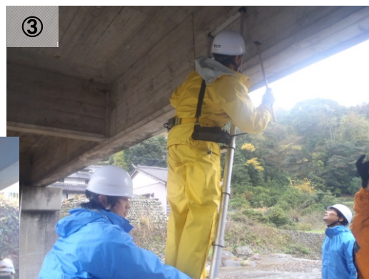
③コンクリート橋桁の打音調査 市道 向山線 ハンマーによる打音調査で コンクリートの浮きや剥離の有無を確認
