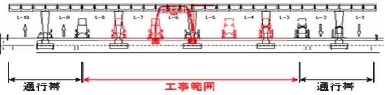
【STEP-2】両端部 料金所屋根、設置機器類の撤去(6月中旬~8月上旬頃)
