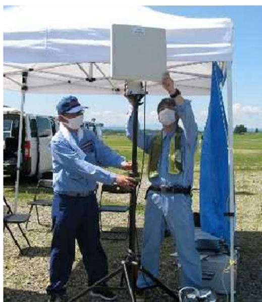
各種データ送受信用5GHz帯 無線アクセスシステム (指向性の強い無線LAN。 10km程度まで通信可)
