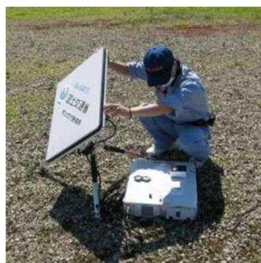
可搬型衛星通信装置 Ku-SAT (ケーユーサット)
