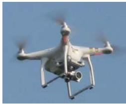
UAV(ドローン等)による3次元測量
