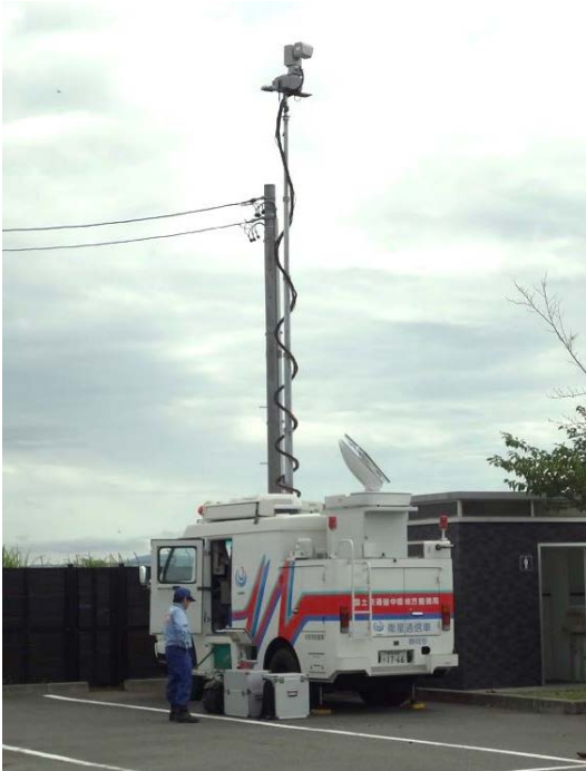
映像配信準備が完了した衛星通信車
