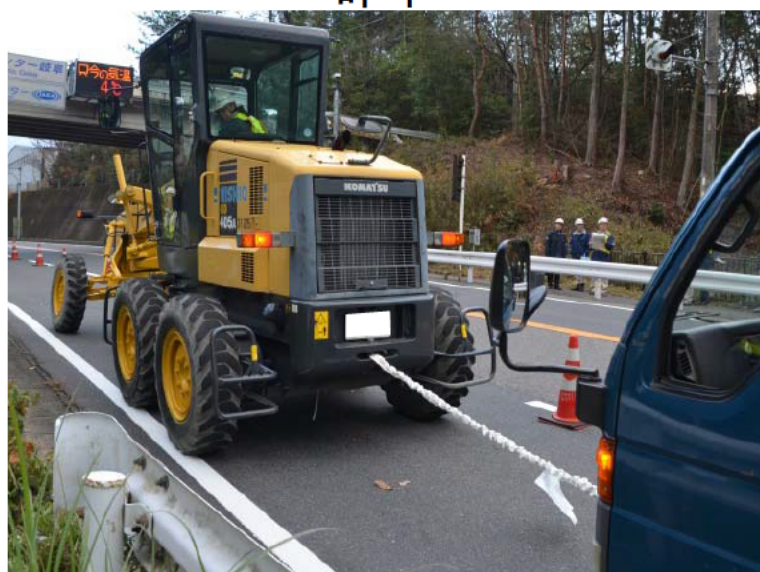
除雪機械による車両の移動（訓練状況）
