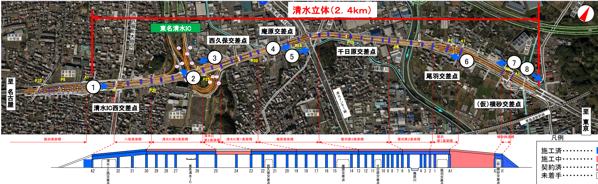
FA1〜P30橋脚 上部工 施工完了 P25〜P30橋脚 床版工 施工中
