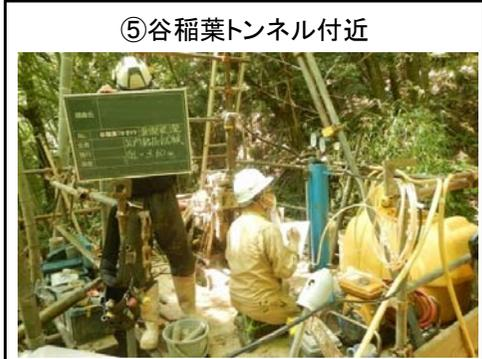
孔内水平載荷試験(普通載荷)実施状況
