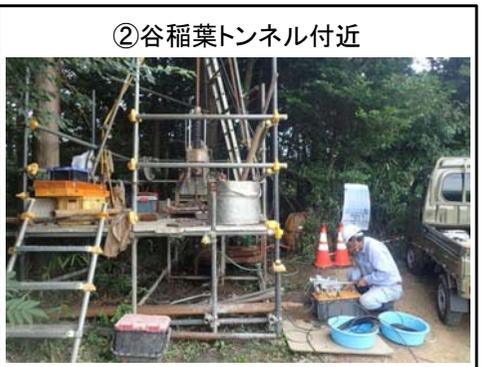
孔内水平載荷試験(高圧載荷)実施状況
