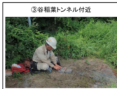
弾性波探査 探査作業実施状況
