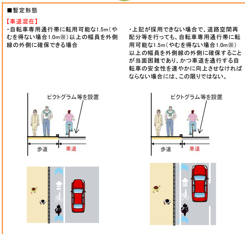
図 3-4 完成形態が自転車専用通行帯の場合の暫定形態選定の考え方
