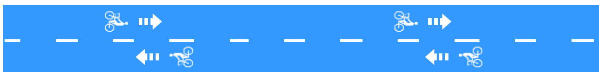
図 4-1 センターラインおよび啓発サインの設置方法
