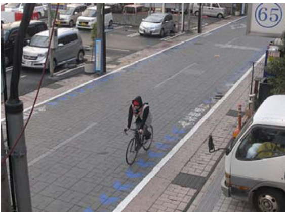
写真 3-5 車道左端部の路肩内に矢羽根型の路面表示を設置した事例 (歩道のない道路)
