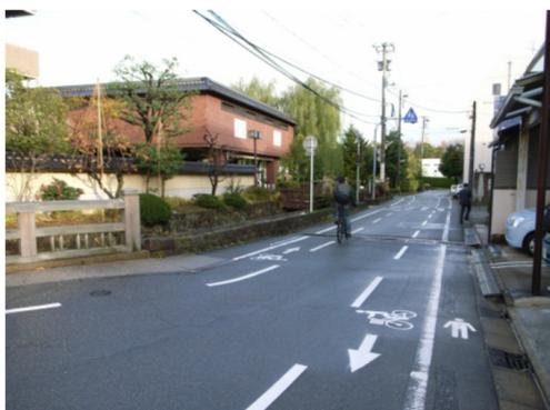
写真 3-8 自転車、歩行者双方の通行空間を路面表示により明確化した事例
