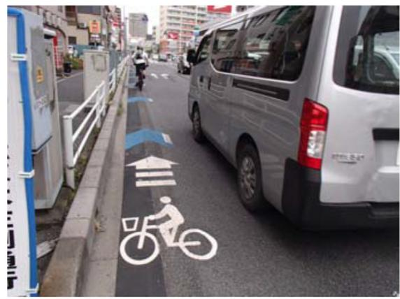
写真 3-4 車道左端部の車線内に矢羽根型の路面表示を設置した事例
