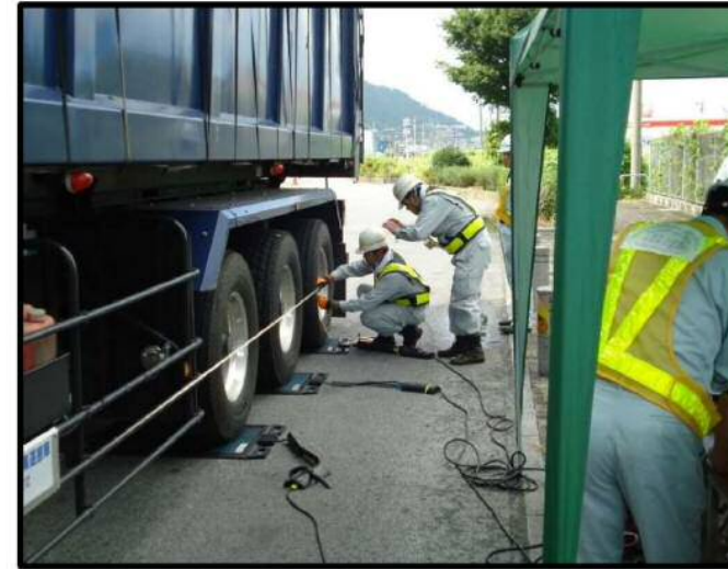
マット式による重量測定状況
