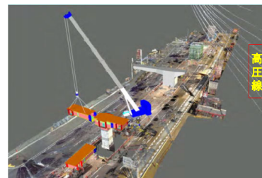
3次元モデルによる施工検討
