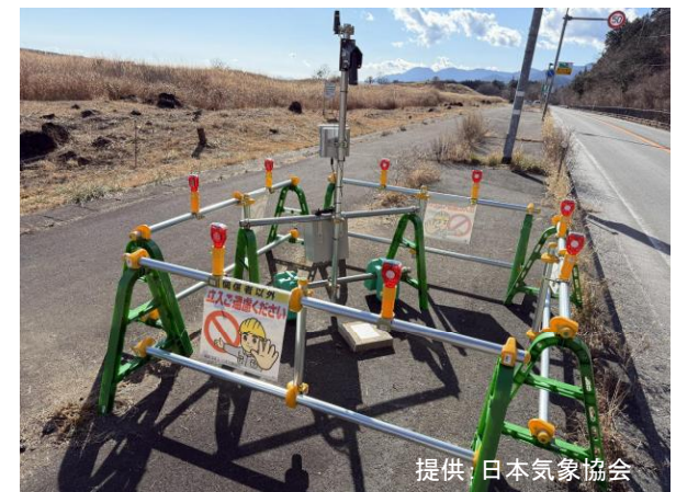
【山梨県境 積雪深計(仮設)による観測】 ※令和7年度以降、本設置を計画中
