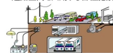
道路陥没のメカニズム例
