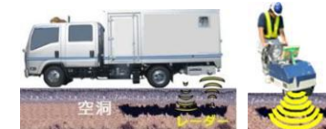
路面下空洞調査
