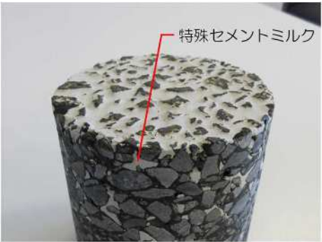
付図 1. 2. 4. 1 半たわみ性舗装のコアの事例
