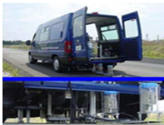
FWDによる健全度診断
