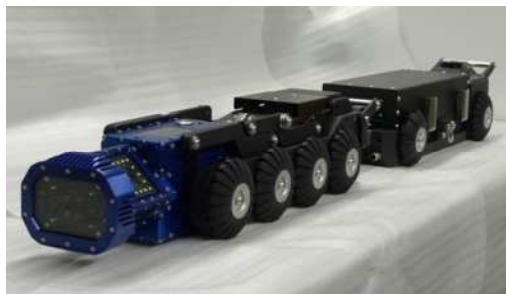
画像認識技術を活用して下水道管路の 欠陥を自動検出する技術
