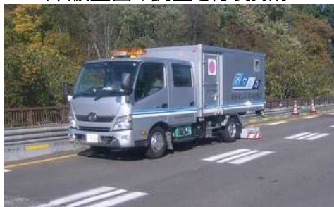
電磁波レーダー搭載車を活用して 床版上面の調査を行う技術
