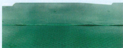
プラスチック素材の膨張によるストレス
