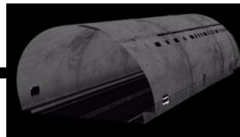
3次元点群データ(トンネル)
