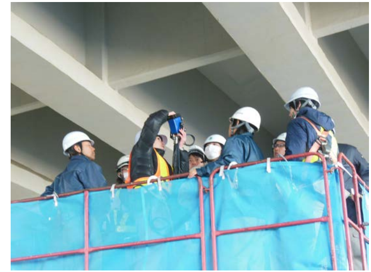
アーム型機械によるコンクリートの浮き・剥離検出技術
