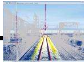
3次元点群データ(鉄道)
