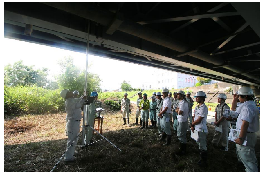
点検機械での実演講習 ロボットカメラ（高所型）
