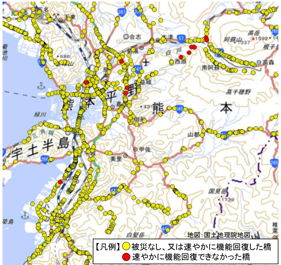
図-1 緊急輸送道路の橋の耐震性能の発揮状況 (熊本県内で震度6弱以上を観測した主な地域)
