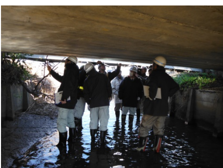
RC橋およびPC橋を近接目視や打音検査の実習しました
