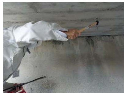
RC橋を近接目視や打音検査の実習しました
